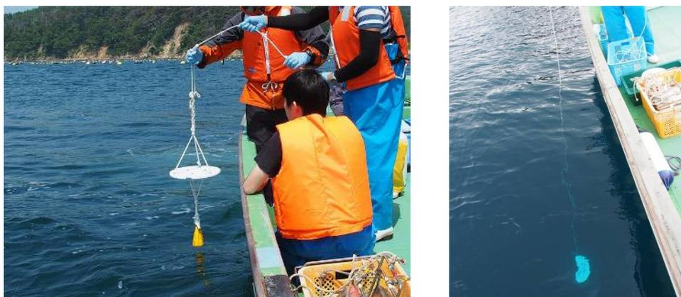
図 2-6-(2) 透明度計測の方法
