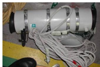
図 2-3-(10) バンドーン採水器
