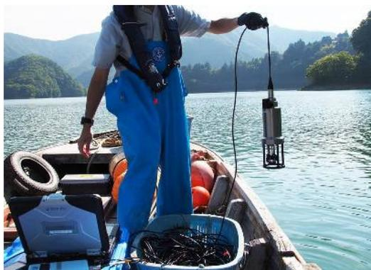
図 2-6-(3) 多項目水質計による蛍光値測定
