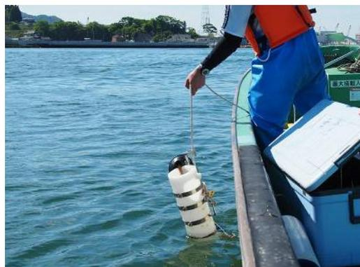
図 2-6-(4) バンドーン採水器による採水
