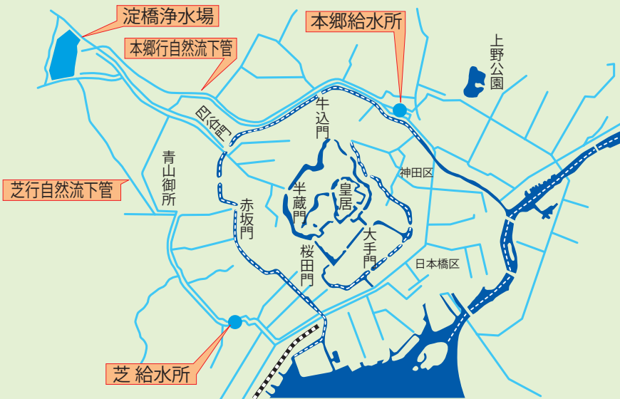
●東京水道鉄管線路略図（明治32年）
