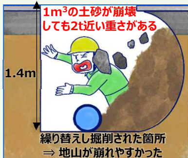
掘削深さ1.4mで発生した土砂崩壊(R4年度)
