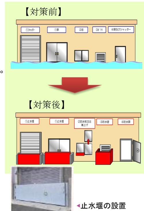
内閣府の中央防災会議「大規模水害対策に関する専門調査会」が公表した河川氾濫による浸水被害想定などに基づき、被害が生じる可能性がある浄水場や給水所などにおいて、施設に止水堰や防水扉などを設置しています。
