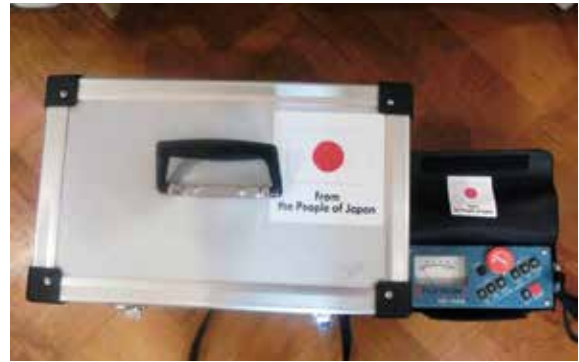
▲ 日本製の電子式漏水発見機
