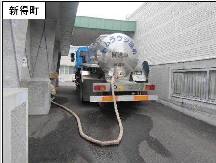
写真-5 温泉輸送車(6t, 加圧有)
