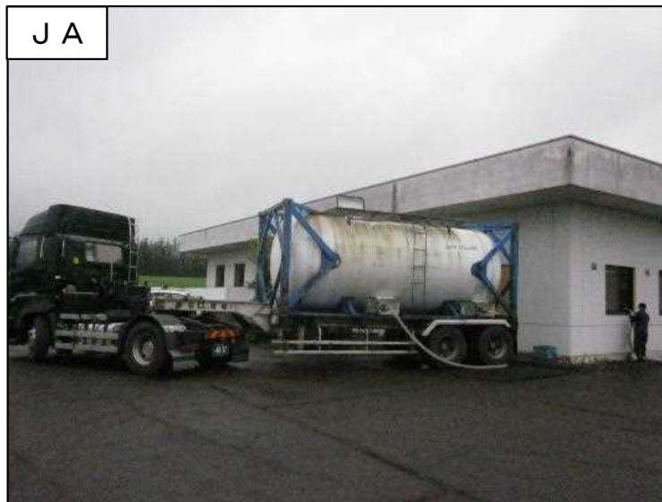
写真-8 ミルクトレーラ(16.8t, 加圧有) ※営農用水供給時に使用
