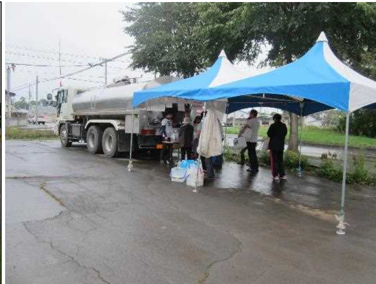
写真-7 ミルクローリー(10t×3台, 加圧有)
