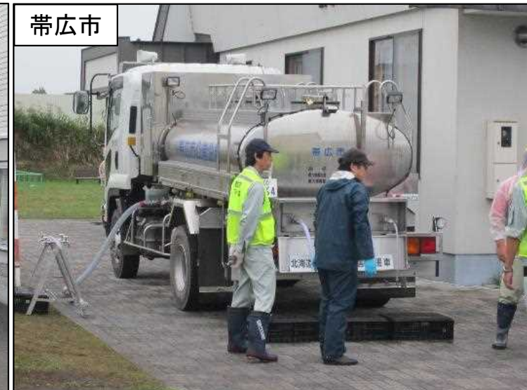
写真-6 給水車(3.1t, 加圧有)
