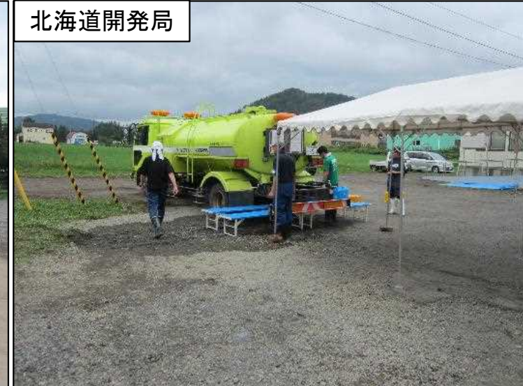
写真-3 散水車(6.3t, 加圧有)
