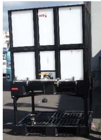
〔札幌市の仮設水槽〕
