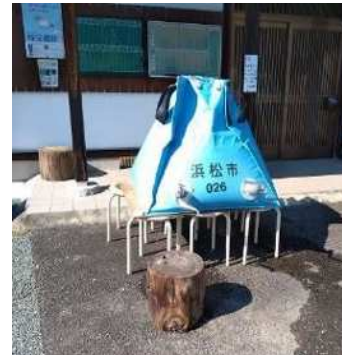
〔浜松市の仮設水槽〕
