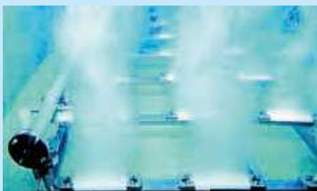
オゾンを注入しているところ
