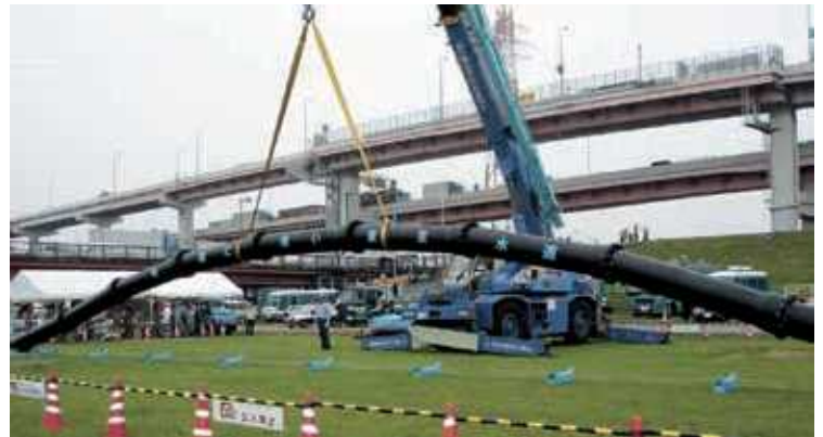
▲継手に外れ防止機能がついた水道管
