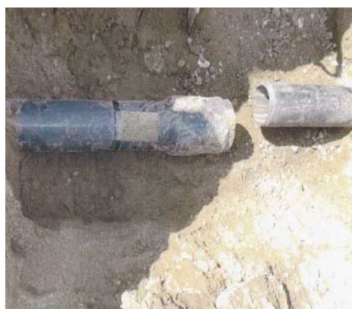
<漏水した塩化ビニル製の給水管>
