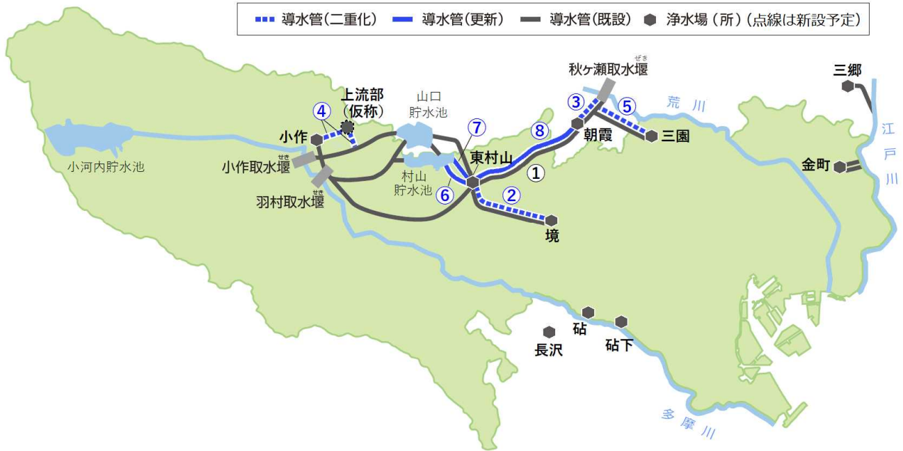
< 導水施設の二重化・更新の概略図 >
