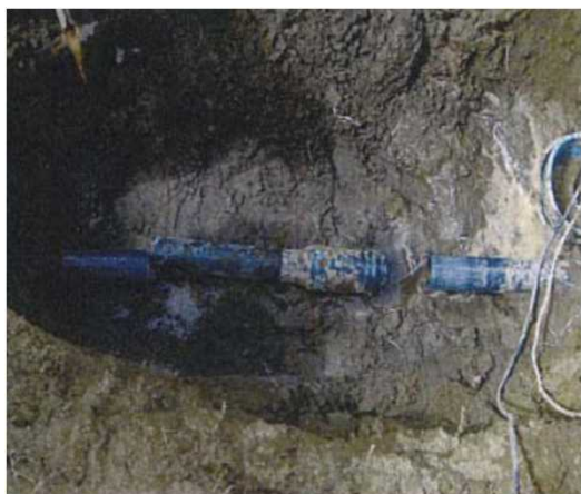
<漏水した塩化ビニル製の給水管>
