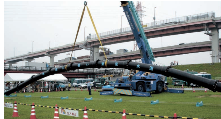
▲継手に外れ防止機能がついた水道管 強い材質の水道管に外れ防止機能がついているため、何本もつないで吊り上げても、途中から折れたり外れたりしません。
